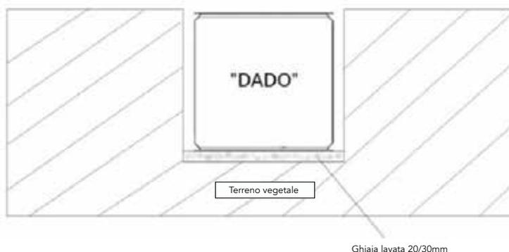
2.2 - Dopo aver riempito e rinfiancato in modo adeguato il serbatoio, ricoprirlo gradualmente con del terreno vegetale (NON DI NATURA ARGILLOSA/LIMOSA, NON MATERIALE DI SCAVO) per 30/40 cm, lasciando liberi i tappi di ispezione. In questo modo l'area interessata è pedonabile ed è vietato il transito di automezzi fino a 2 metri di distanza dallo scavo.
